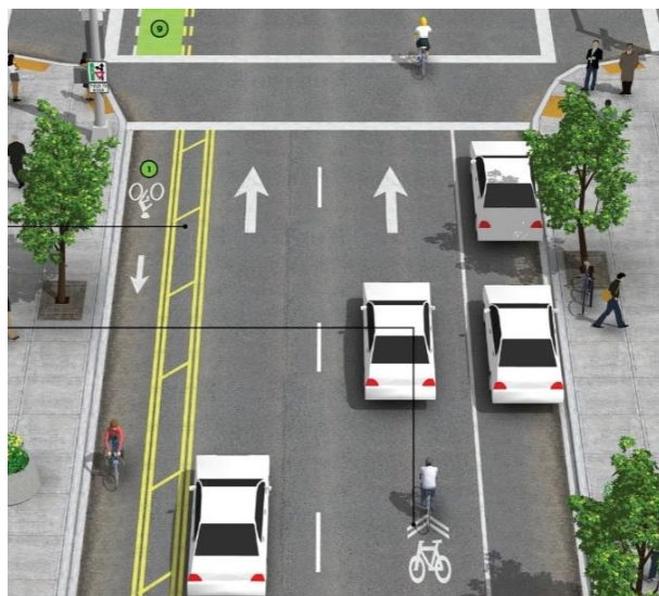
Rysunek 1.13 Przykład zastosowania kontrapasa rowerowego
