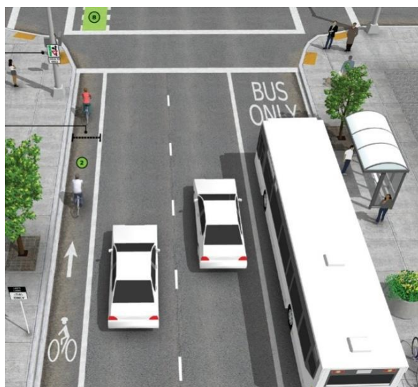
Rysunek 1.14 Przykład zastosowanie pasa rowerowego po lewej stronie
