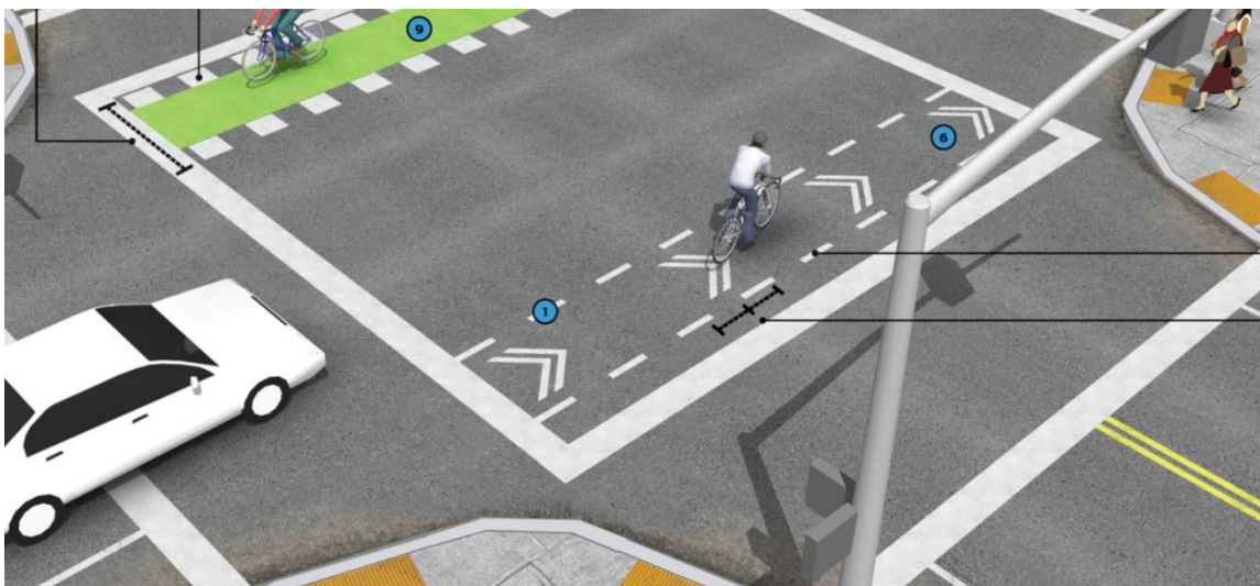
Rysunek 1.16 Przykład oznakowania poziomego na tarczy skrzyżowania
