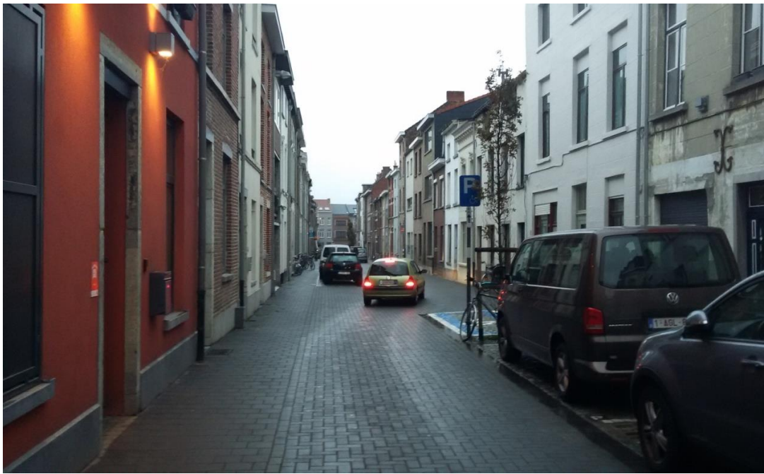
Rysunek 4.4 Sposoby wymuszania redukcji prędkości - przerwanie ciągłości ulicy dla samochodów oraz przestrzeń wspólna z naprzemiennym parkowaniem Źródło: zasoby własne
