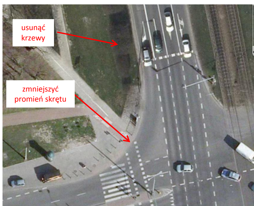
rys. 36. propozycje zmian geometrycznych podyktowane poprawą BRD
