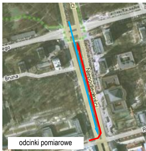
rys. 20. odcinki pomiarowe czasu przejazdu tramwajów
